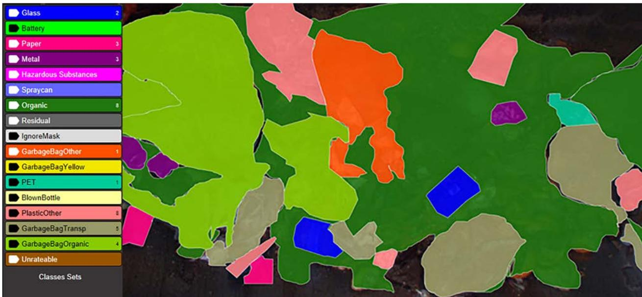
**Abbildung 3:** Aufnahme eines geschütteten Bioabfalls mit Flächenmarkierungen der Fremdstoffe, links: Kategorien
