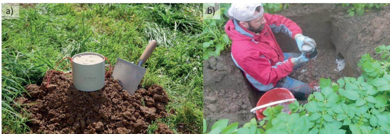
Abbildung 1: a) SIA für Nitrat (Höhe und Durchmesser jeweils 10 cm); b) Installation der SIA für PSM (Hülle aus Edelstahl).
