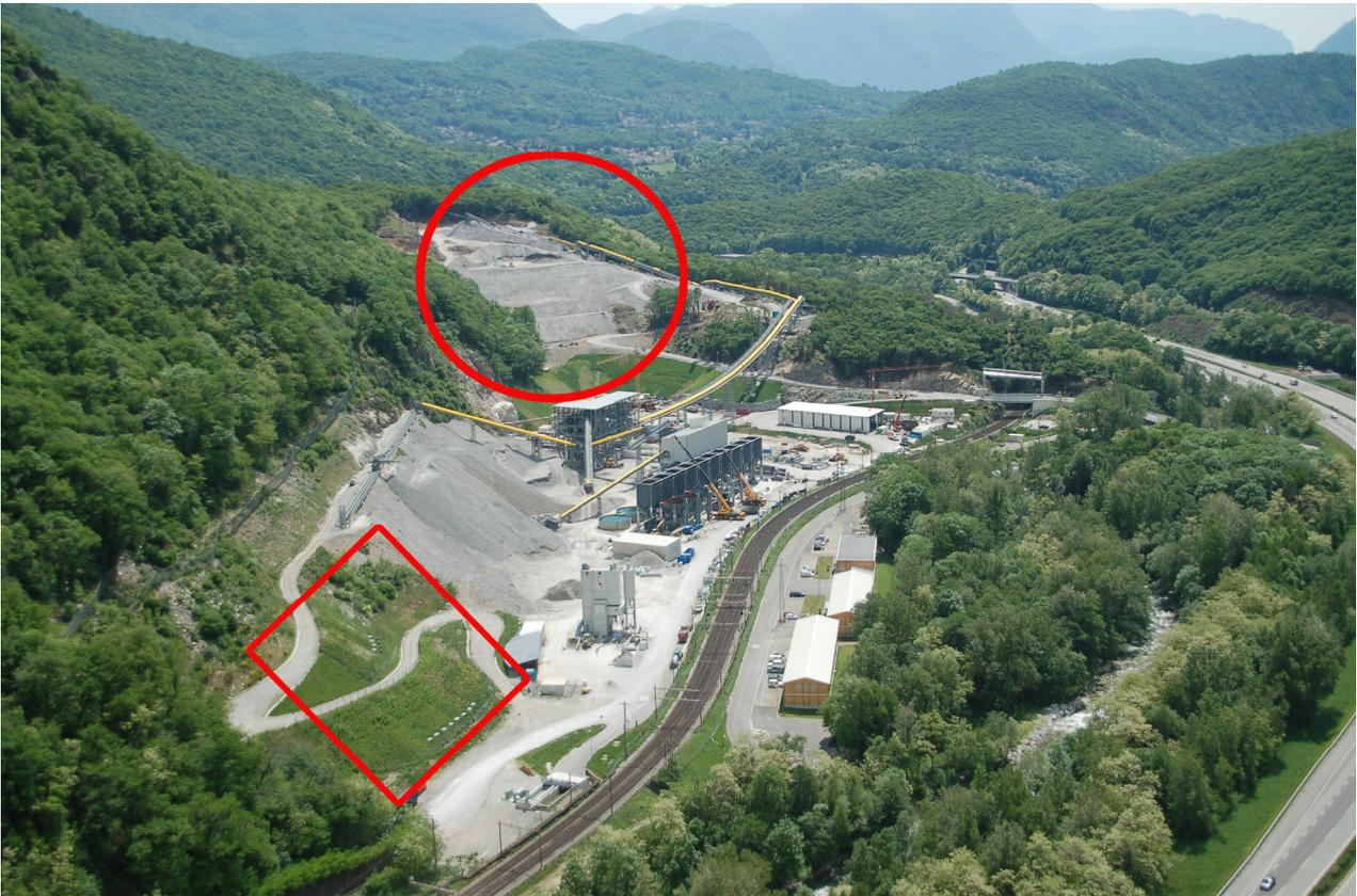
Abb. 1: Übersicht der AlpTransit Baustelle von Sigrino. Im Hintergrund befindet sich die Ablagerung (Kreis), während im Vordergrund links liegt die Renaturierungsversuchsfläche (Rechteck).
