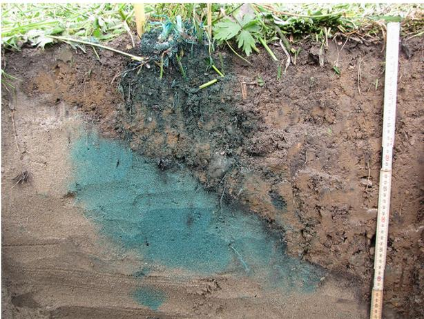
**Abbildung 6:** Fließmusterbild am Standort Forch 6, bei dem im Bereich des Zulaufes nachträglich Sand in den bestehenden Bodenfilter eingebaut wurde. Die Abbildung zeigt die «Böschung» der Sandschicht; der Boden wurde nach Einbringen des Sandes wieder darüber gezogen, um eine gleichmässige Oberfläche zu erhalten.
