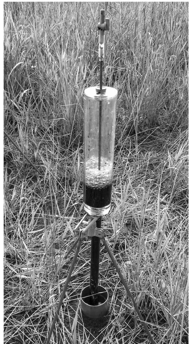
**Abbildung 3:** Boyle-Mariott'sche Flasche für die Messung der Infiltration, gefüllt mit der Tracerlösung.
