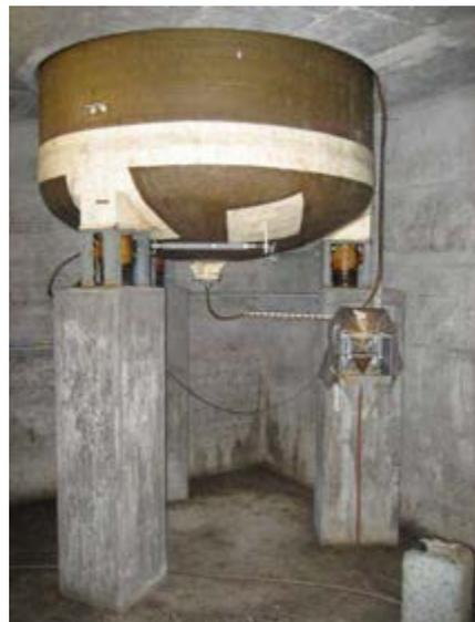
Lysimeterkeller mit Kippwaage für Sickerwassermessung.
