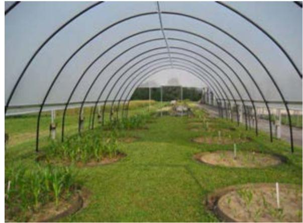
Lysimeteranlage mit Blick auf die überdachten 12 Lysimeter mit 3,1 m<sup>2</sup> Oberfläche und Maisanbau.
