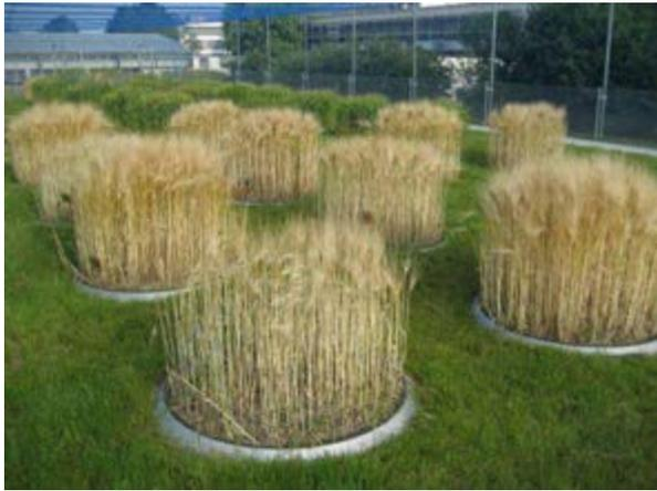
Lysimeteranlage mit Blick auf einen Teil der 72 Lysimeter mit 1 m<sup>2</sup> Oberfläche (vorne mit Wintergerste).
