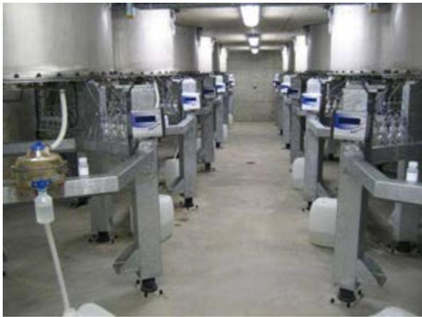
Lysimeterkeller mit wägbaren Lysimetern, Kippwaagen für Sickerwassermessung, Probennahmeflaschen und Messsonden.
