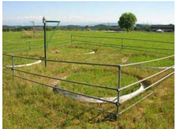
Lysimeteranlage; Blick auf die 4 Lysimeter mit 3,1 m<sup>2</sup> Oberfläche und Graslandnutzung.
