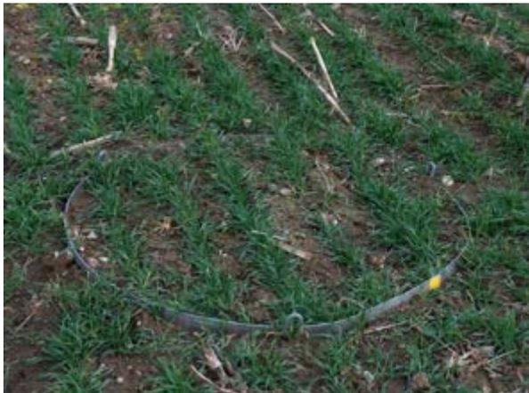
Eingebauter Feldlysimeter mit 1 m<sup>2</sup> Oberfläche im Direktsaatverfahren mit Winterweizen.
