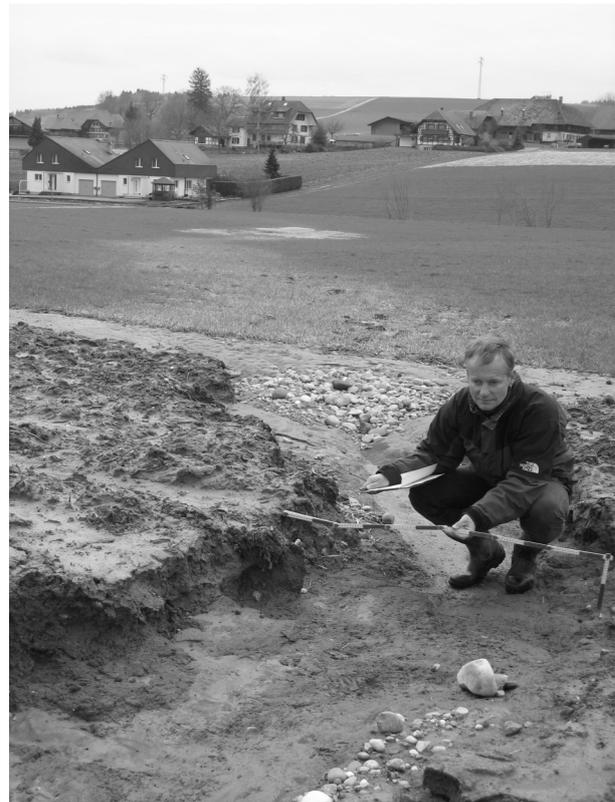
**Abb. 1:** Vermessen und Kartieren von Erosionsformen im Feld.
