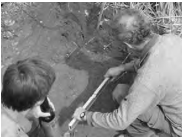
Abbildung 5: Bodenforschung sucht Zugang zu versteckt ablaufenden Prozessen – Einbau von Messsonden in ein Bodenprofil (Bild: M. Holpp).
