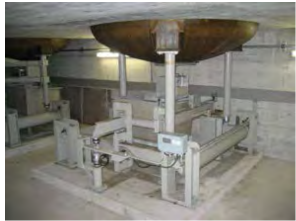
Lysimeterkeller mit Wägevorrichtung.
