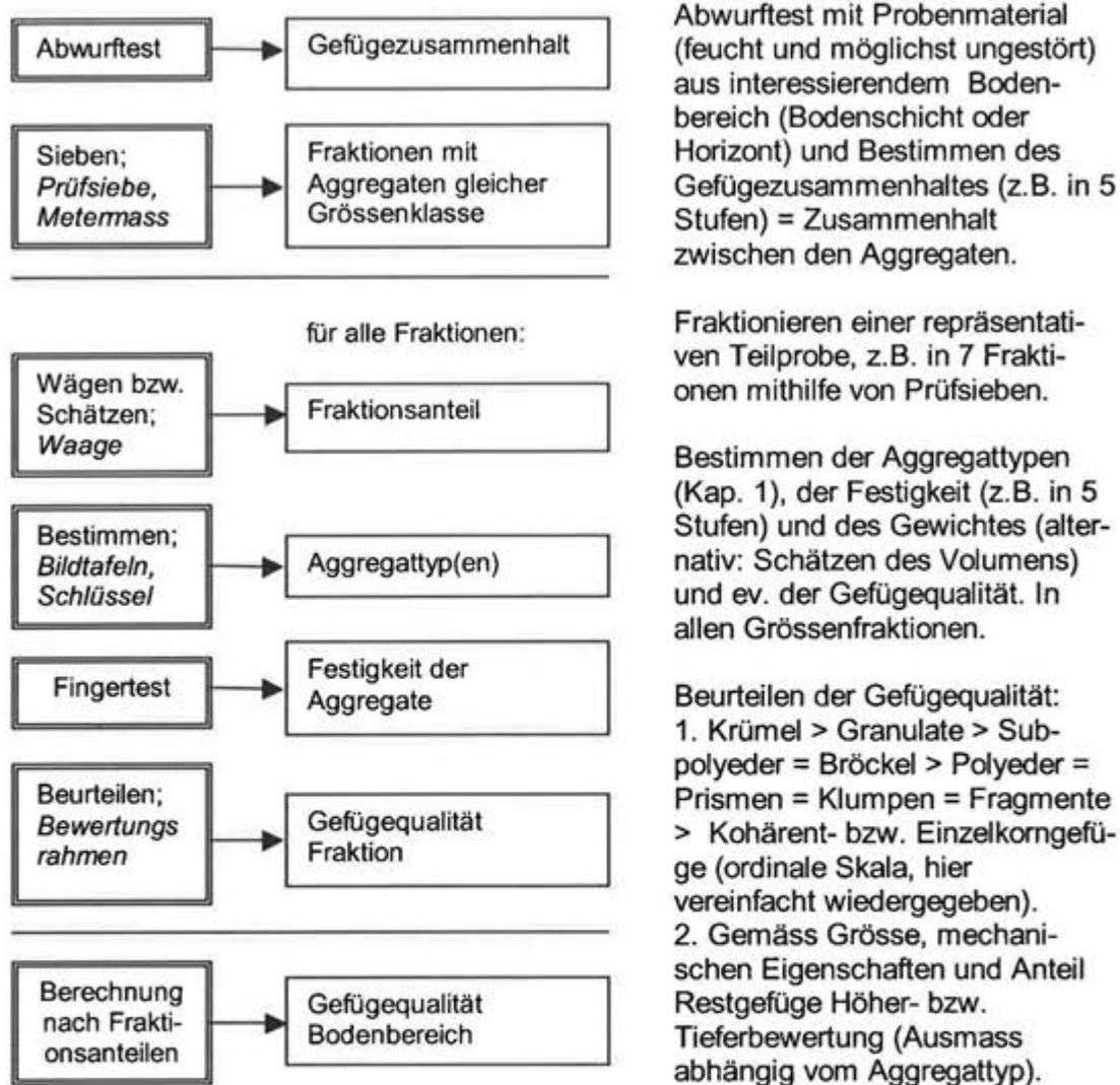
Abbildung 2. Schematischer Ablauf der visuellen Gefügeansprache
