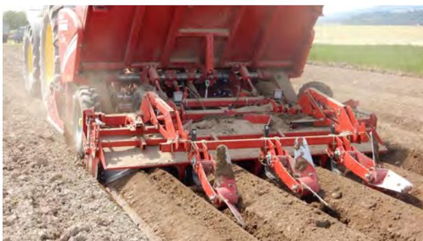
Abbildung 6: Lochstern (Dyker) an einer Kartoffellegemaschine Grimme GL 420 (All-in-One) (Foto: T. Lemann, CDE).
