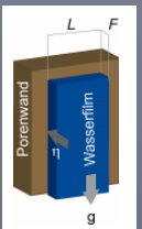
Abbildung 2: Modellvorstellung des Wasserflusses in Form von Wasserfilmen
